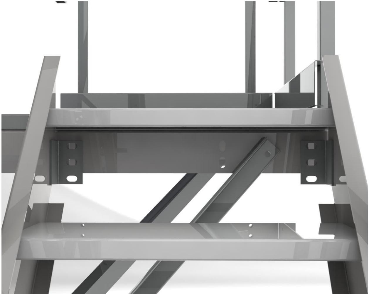
Atornille la baranda de la escalera en la cara externa de la zanca de la escalera. Observe que se requieren sólo 2 tornillos por poste de baranda. Se proporcionaron 3 agujeros en el perfil de la zanca por si hay obstrucciones.
