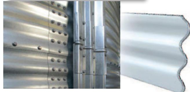
Die Blechhöhe beträgt 1077 mm und vermindert somit erheblich die Anzahl Ringe, Verschraubungen und Stützenverbindungen. Dieser Vorteil, verbunden mit unserer neuen exklusiven "W" Stütze, bietet eine unerreichte Belastung und reduzierte Montagedauer an.
