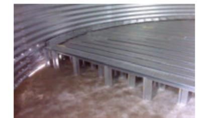
Belüftung durch Halbbrundkanäle, Schlitzlochbleche, Siebboden.
