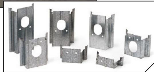
Los soportes para piso están disponibles en ejecución multi-plancha soldados (superior) o plegados Channellock (inferior) para ser usados en aplicaciones de 13" y 17" (330 mm y 432 mm) de altura, así como alturas adicionales de soporte. Los soportes plegados Channellock están disponibles en material galvanizado calibres 16 ó 18.
