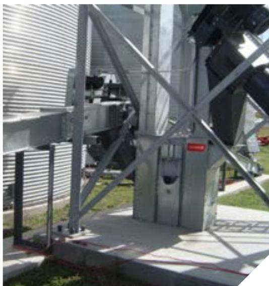
Hay disponibles secciones para el pie con sistema tensor manual y una variedad de secciones intermedias para adecuarse a cada necesidad.
