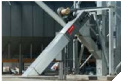
Éstos pueden ser instalados en fosos poco profundos o ser usados en instalaciones sobre el piso con área de descarga elevada. Como sucede con los transportadores a cadena horizontales, estos modelos brindan flexibilidad y confiabilidad inigualables.
