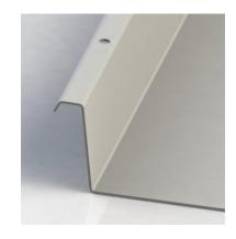
Los clips de sujeción galvanizados de grueso calibre para el alero se atornillan directamente al panel del techo y la lámina de pared. Estos clips son regulables con agujeros alargados para levantar o bajar el techo según se desee. Los "Clips a prueba de Huracanes" son estándar en todos los silos para reforzarlos contra las fuerzas del viento.
