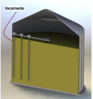
Los helicoidales verticales pueden requerir que se los acorte para que haya un huelgo mínimo con el piso de 3" - 5" (76 mm – 127 mm) o un mayor espacio para barredoras. Siempre se debe seguir el procedimiento del fabricante para acortarlo.
